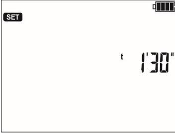
El tiempo de duración de una medición en el rango 30 s ... 5 min.
