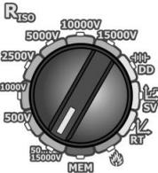
Ajustar el interruptor de función en la posición de medición  $R_{150}$ .
