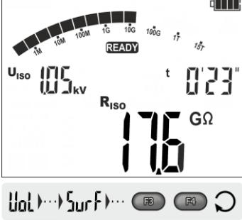
Después de completar la medición se pueden leer los resultados. Con los botones **F3** y **F4 (PANTALLA)** se puede ver los distintos componentes en el orden:
