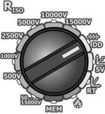
El conmutador rotativo de selección de función debe ser puesto en la posición **DD**.
