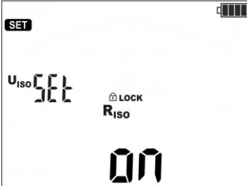
**Prueba de tensión** activación (ON) y desactivación (OFF).
