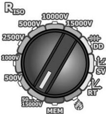
El conmutador rotativo de selección de función debe ser puesto en la posición **50...15000 V**.
