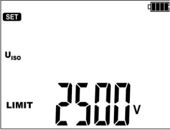
La tensión de medición final  $U_{iso}$  **LIMIT**. Está en el rango de 50 V...15 kV.
