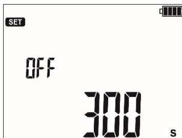
Tiempo **hasta el apagado automático** (300 s, 600 s, 900 s) o falta de tiempo (- - - -).
