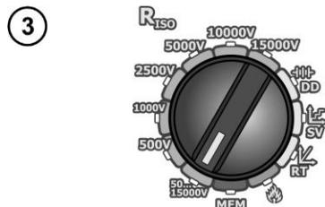
El conmutador rotativo de selección de función debe ser puesto en la posición **50...15000 V**.
